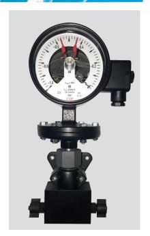
Le vacuostat permet de vérifier à tout moment le bon fonctionnement en dépression de votre installation et surtout l'étanchéité des circuits de chlore : l'aiguille noire du cadran indique en permanence la valeur du vide du circuit.
