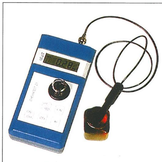
*Photomètre de précision portable pour la détermination spectrophotométrique du désinfectant, du fer, de l'aluminium. Mesure par électrode du pH et du Redox.*
